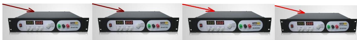
Рисунок 2 – Схема пломбировки от несанкционированного доступа.
