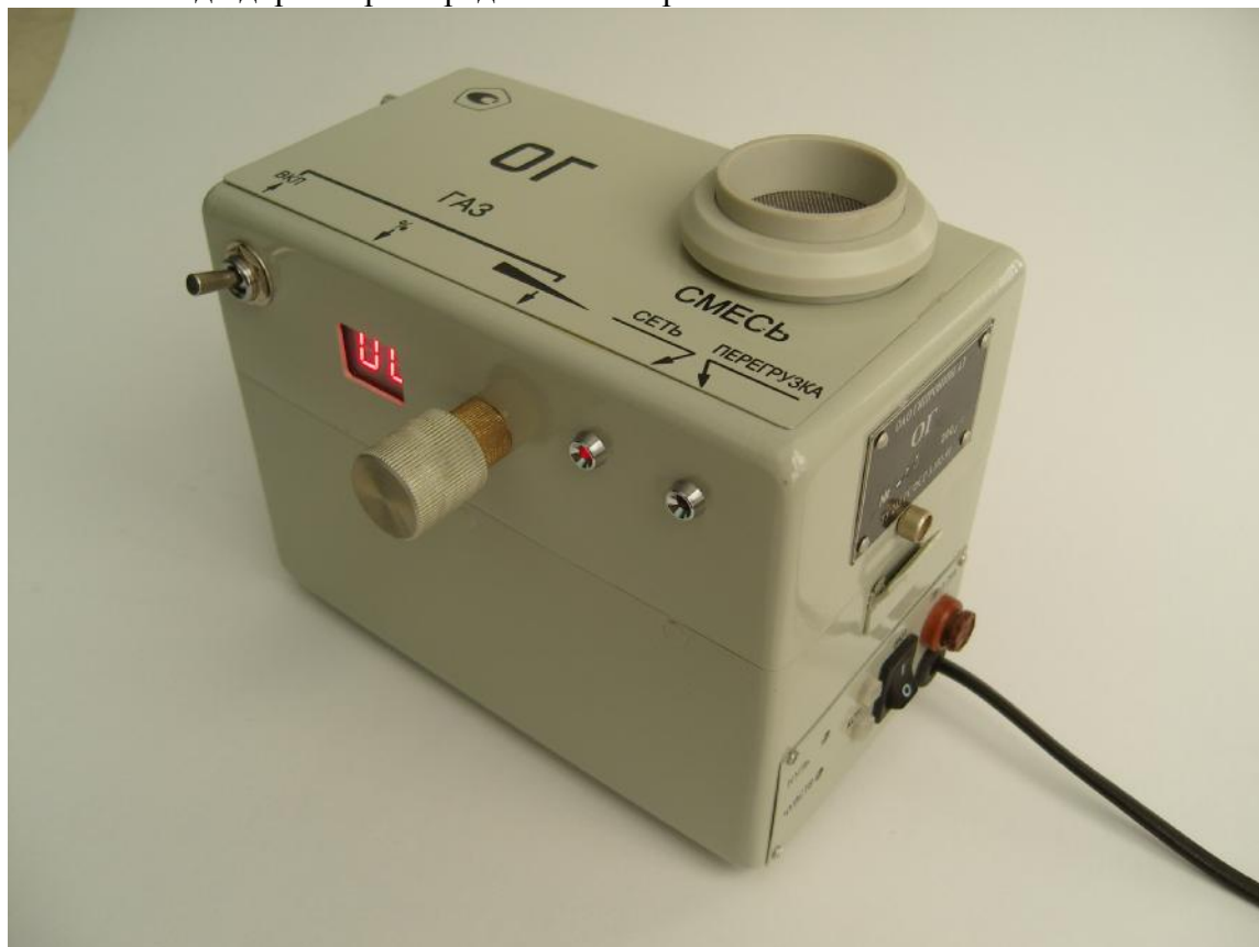
Рис. 1. Внешний вид одориметров газа ОГ ОГ-05-00-00
