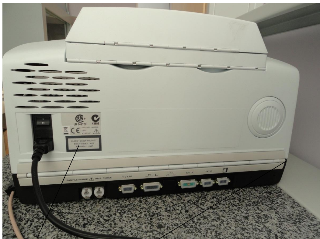
Рисунок 4 - Фурье-спектрометр инфракрасный Frontier DTGS - вид сзади 1 - маркировка ; 2- место пломбирования;
