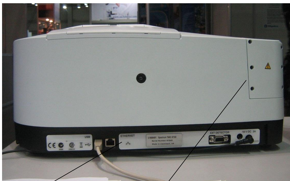
1 2 Рисунок 2 - Фурье-спектрометр инфракрасный Spectrum Two DTGS - вид сзади 1 - маркировка ; 2- место пломбирования;
