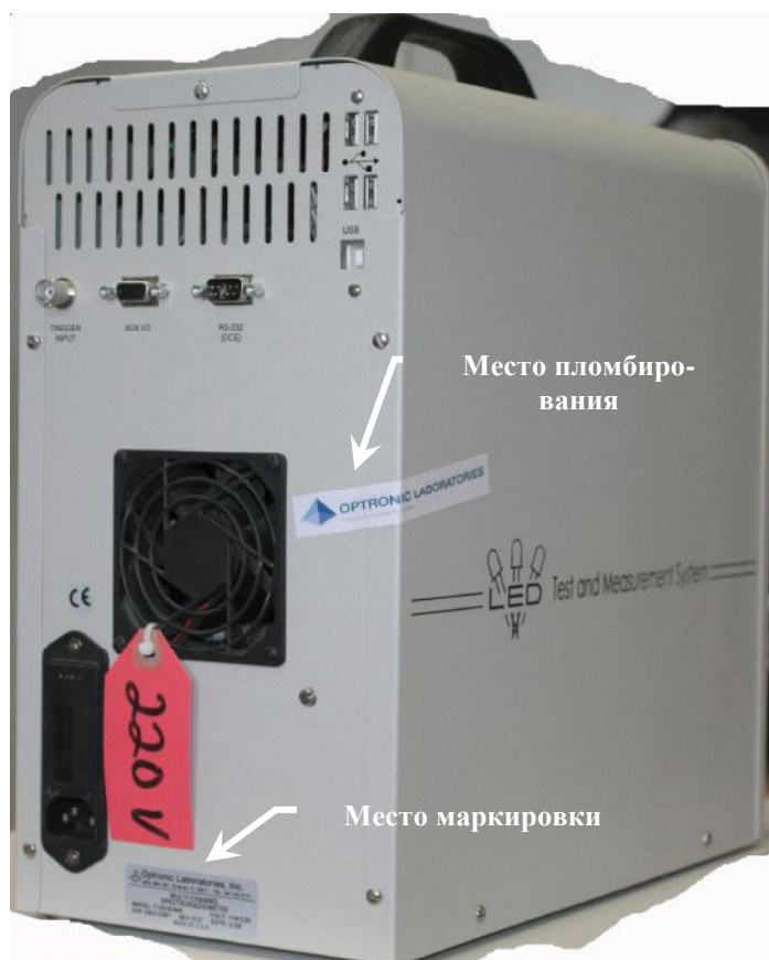
Рисунок 3 - Схема маркировки светонепроницаемой трубы OL 15AB
