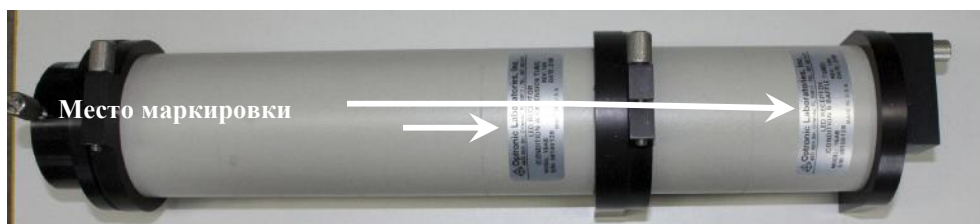
Рисунок 3 - Схема маркировки светонепроницаемой трубы OL 15AB
