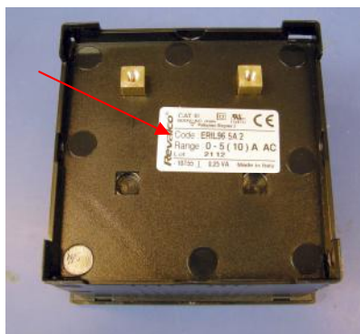
Рисунок 2 - Схема пломбировки от несанкционированного доступа амперметров, вольтметров ERI, ERC, ERIL, ERCL
