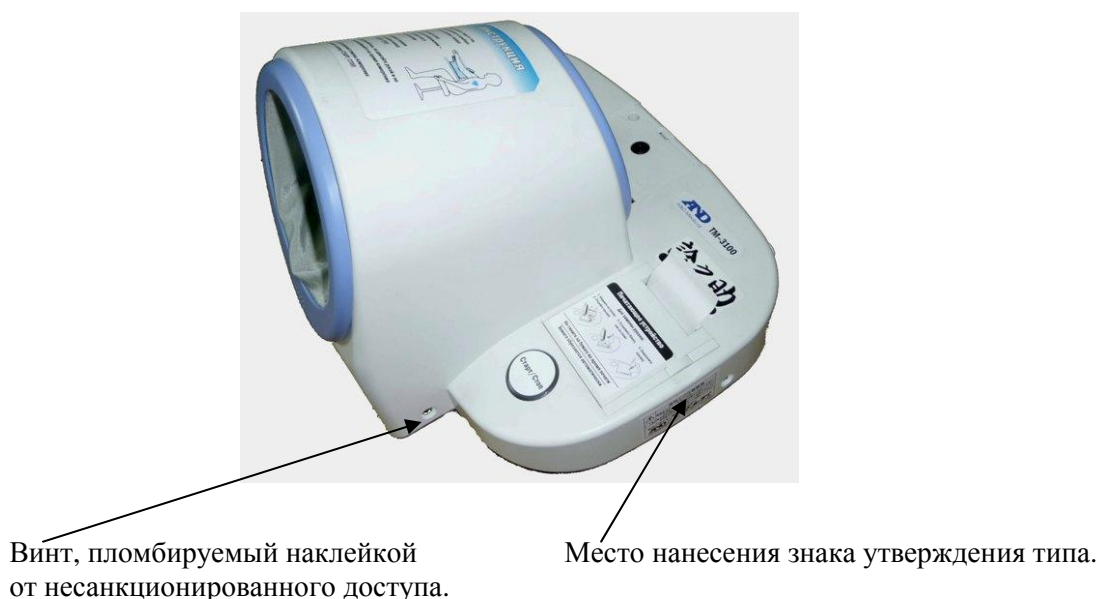
Рисунок 2 – Общий вид приборов для измерения артериального давления и частоты пульса цифровых ТМ-3100, схема пломбировки от несанкционированного доступа и размещения наклейки знака утверждения типа.
