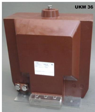
Выпускаются две модификации трансформаторов UKM 24/3 и UKM 36, которые рассчитаны на различные наибольшие рабочие напряжения от 12 до 40,5 кВ, которые различаются также номинальными первичными напряжениями, габаритами и весовыми характеристиками. Первичные и вторичные обмотки залиты специальной смолой, которая обеспечивает основную изоляцию и создает "корпус" трансформатора.
