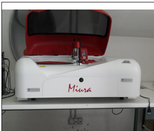
Рисунок 1 – Анализатор автоматический биохимический модели MIURA
