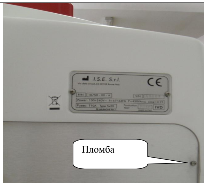
Рисунок 6 – Расположение пломбы. Анализатор автоматический биохимический модели MIURA ONE
