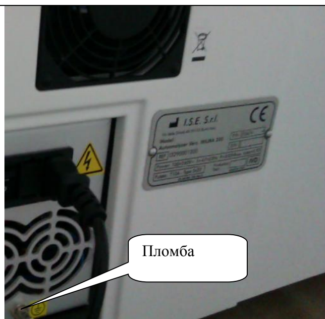
Рисунок 4 – Расположение пломбы. Анализатор автоматический биохимический модели MIURA 200
