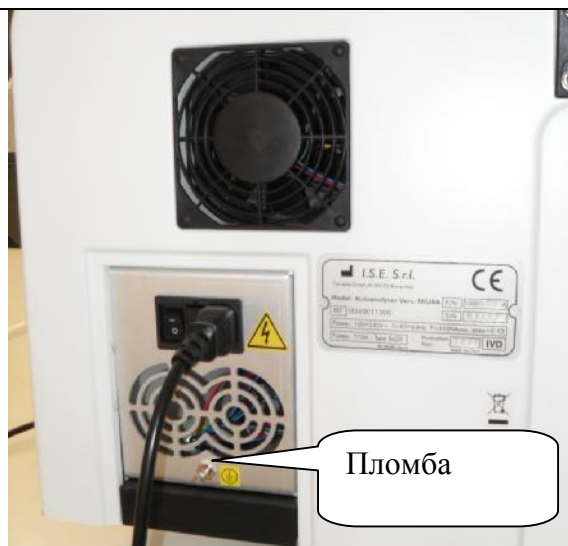
Рисунок 2 – Расположение пломбы. Анализатор автоматический биохимический модели MIURA
