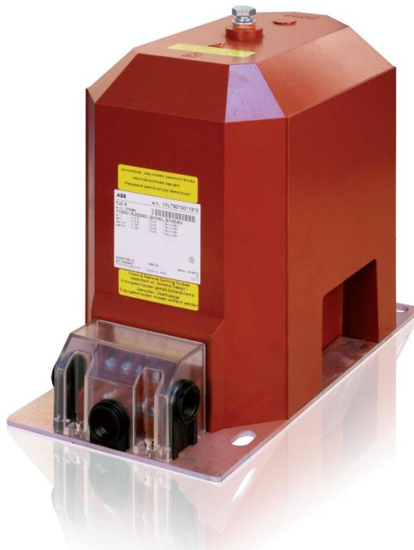
Выводы вторичных обмоток помещены в контактной коробке, закрепленной на основании и закрываемой съемной изоляционной пломбируемой крышкой. Трансформаторы имеют клемму заземления с винтом М8. Для крепления в месте установки на опорной поверхности трансформаторов имеются отверстия под болты М10. На узкой боковой стенке корпуса трансформаторов размещена табличка технических данных.
