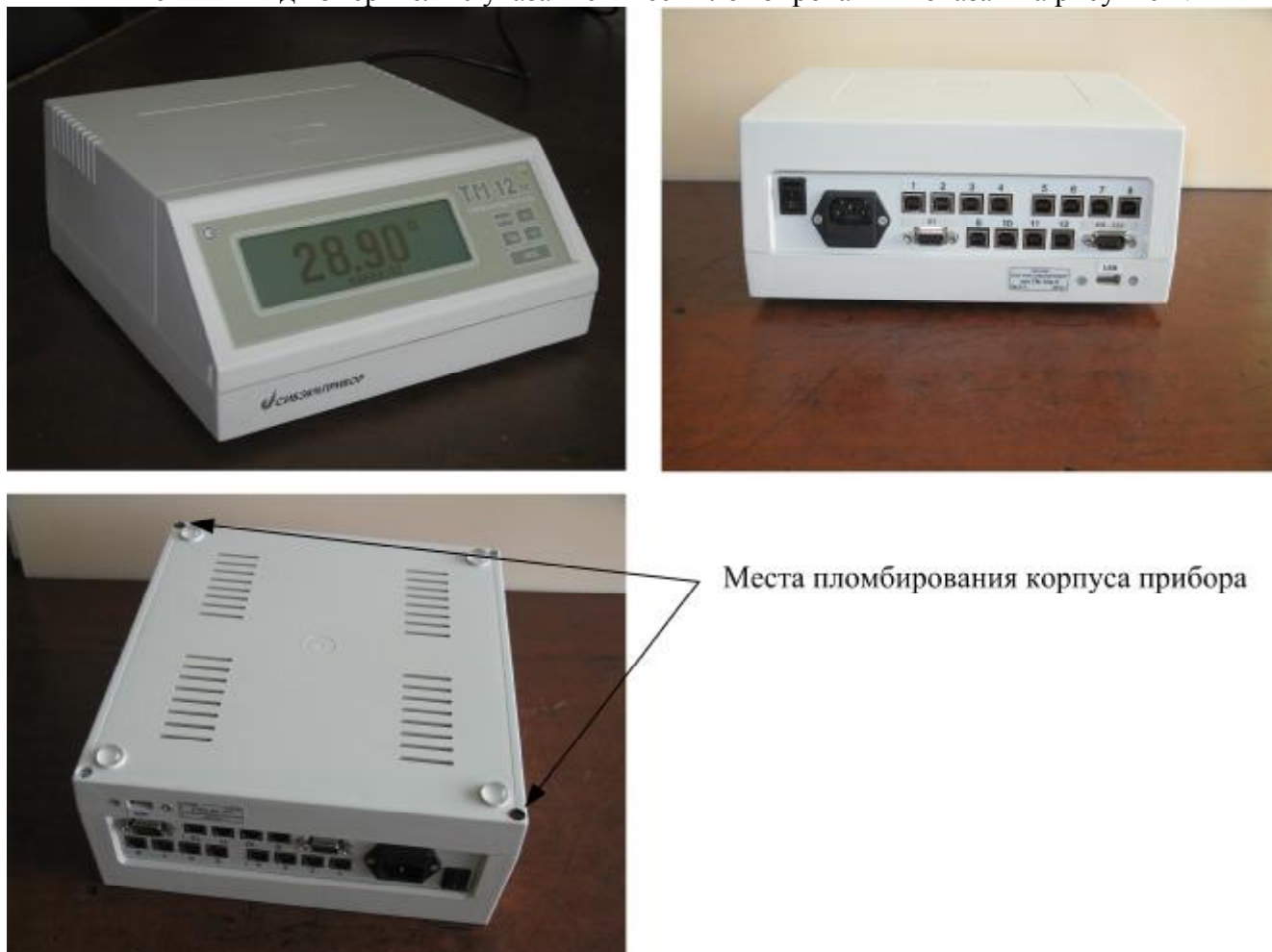
Рисунок 2. Внешний вид измерителя и места пломбирования корпуса
