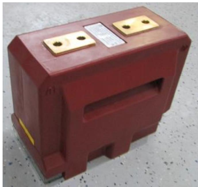
Трансформаторы, имеющие в своем обозначении букву «Б» справа и слева от контактных площадок имеют изоляционные перегородки (барьеры), увеличивающие расстояния для поверхностных токов утечки.
