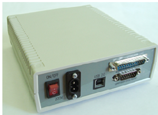
Рисунок 1 – Общий вид меры горизонтального перемещения нанометрового диапазона МПГ и электронной системы управления.
