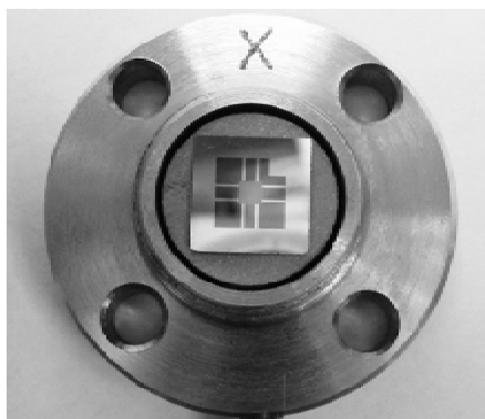
Рисунок 1 – Общий вид меры горизонтального перемещения нанометрового диапазона МПГ и электронной системы управления.
