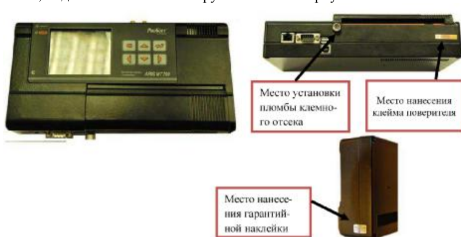
Рисунок 1 – Общий вид и места пломбирования контроллера ARIS MT700
