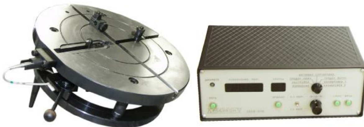
Рисунок 1- Общий вид прибора для измерения диаметра отверстий внутренних колец подшипников 4151-С
