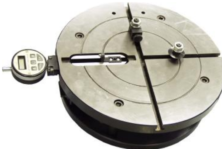
Рисунок 1- Общий вид прибора для измерения диаметра отверстий внутренних колец подшипников 4151
