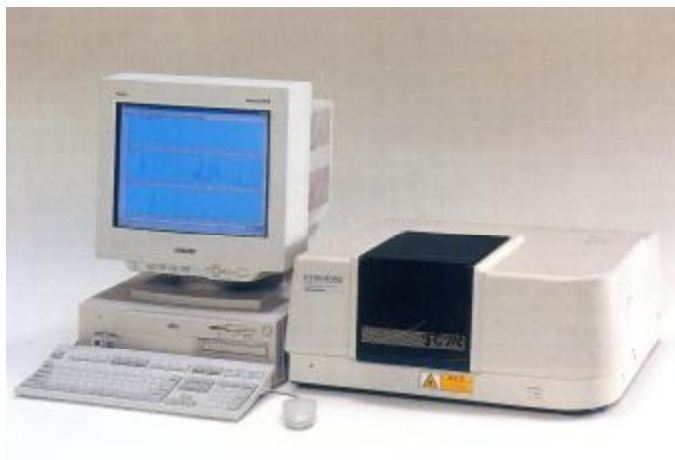
Рис. 1 Внешний вид Фурье–спектрофотометра инфракрасного модель FTIR–8301PC.
