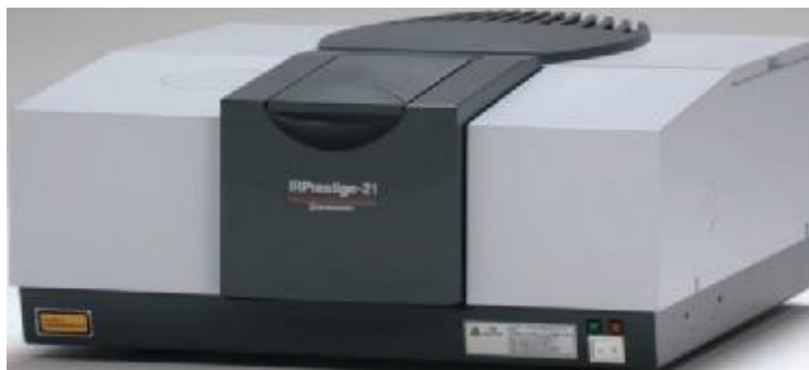
Рис. 4. Внешний вид Фурье–спектрофотометра инфракрасного модель IRPrestige–21.
