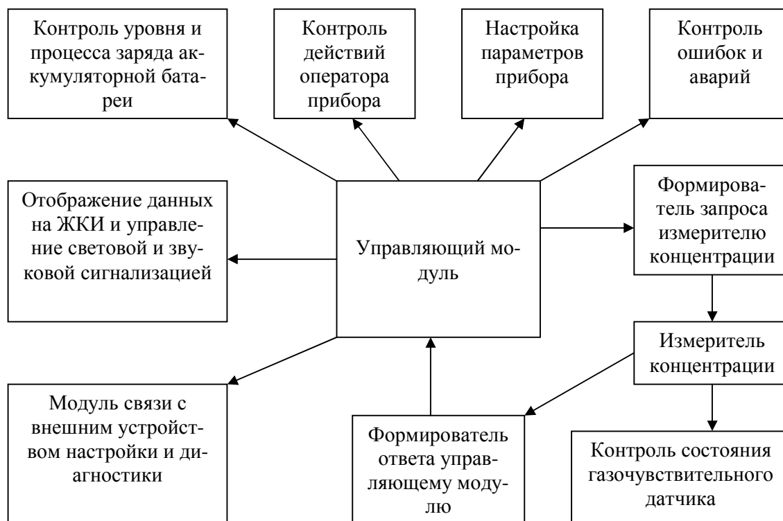
Рисунок 3. Структура ПО газоанализатора ФП11.2к
