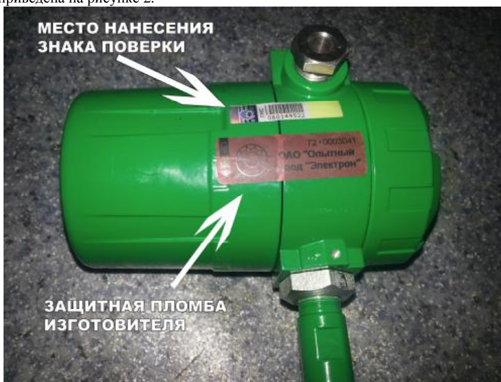
Рисунок 2 Схема пломбирования датчиков расхода счетчика ДРС.М от несанкционированного доступа.
