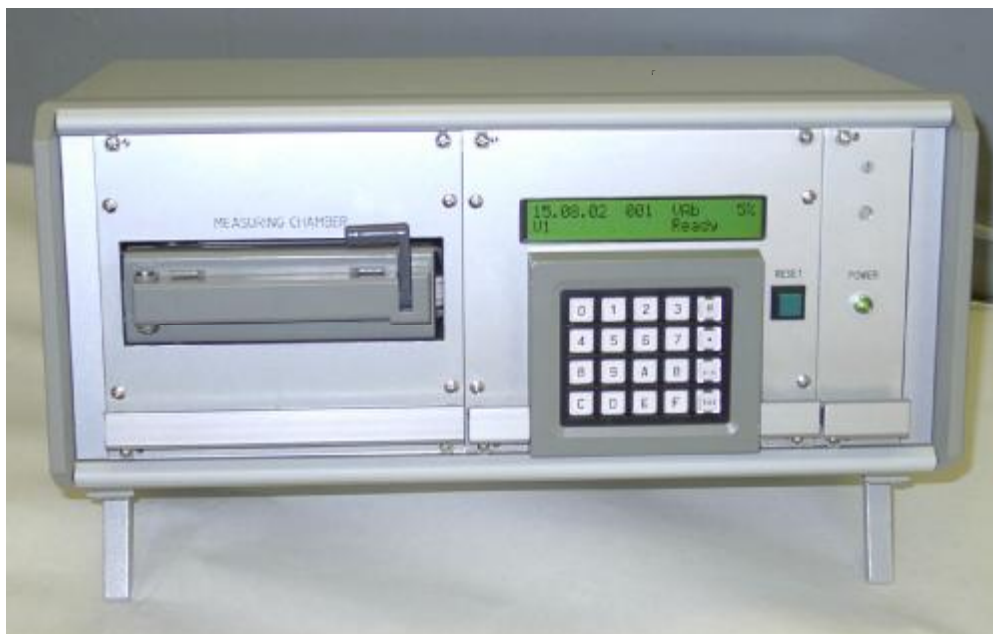
Рисунок 1 – Фотография радиометра RKS-18R
