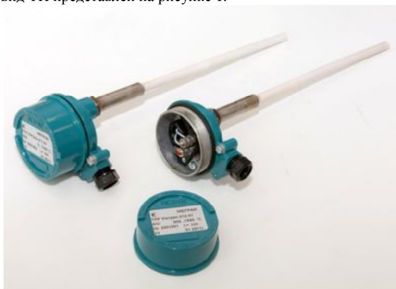
Рисунок 1 – Преобразователи термоэлектрические ТПП Метран-211, ТПР Метран-212
