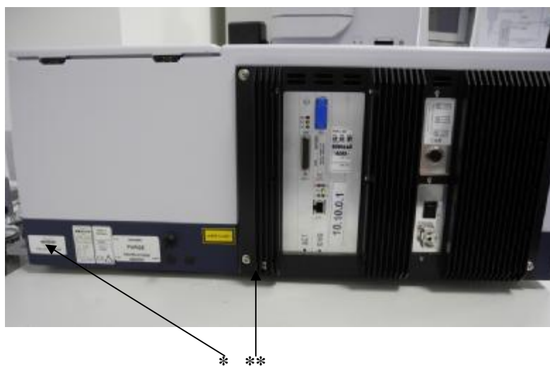
Рисунок 2. Задняя панель Фурье-спектрометра моделей TENSOR 27, TENSOR 37, *-место маркировки, ***- место пломбирования
