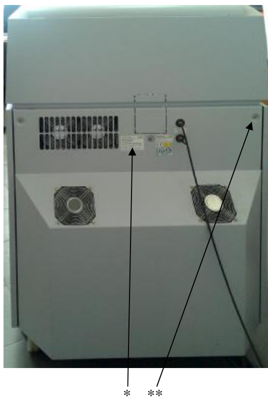
Рисунок 2- Задний план спектрометра последовательного рентгенофлуоресцентного S4 PIONEER, *-место маркировки, **- место пломбирования
