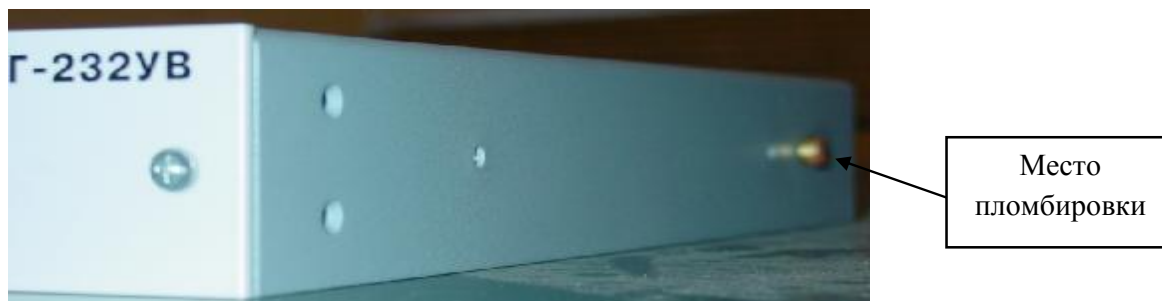
Рисунок 2 – Схема пломбировки генераторов от несанкционированного доступа
