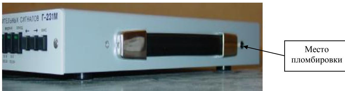
Рисунок 2 – Схема пломбировки генераторов от несанкционированного доступа.
