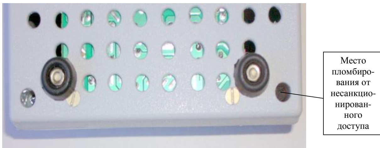
Рисунок 2 - Схема пломбировки электронного блока прибора ПЧП99 от несанкционированного доступа
