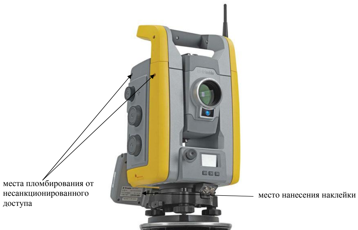
Рисунок 4 - Схема пломбировки от несанкционированного доступа и места нанесения наклейки
