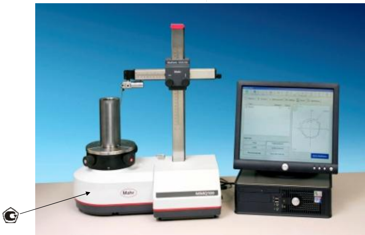
Рисунок 1 – Общий вид прибора для измерений отклонений от круглости Formtester MMQ 100 и место нанесения знака утверждения типа
