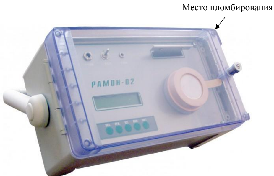
Рис. 1 Внешний вид радиометра радона и его дочерних продуктов распада «РАМОН-02» с указанием места пломбирования
