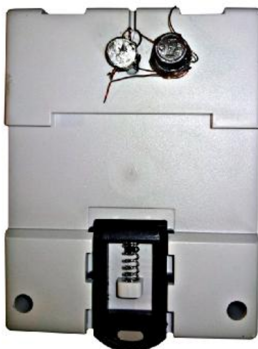
Рисунок 2. Место установки пломбы завода изготовителя (вид сзади).
