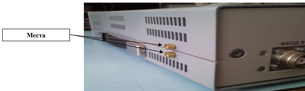
Рисунок 2 – Схема пломбировки приемников от несанкционированного доступа
