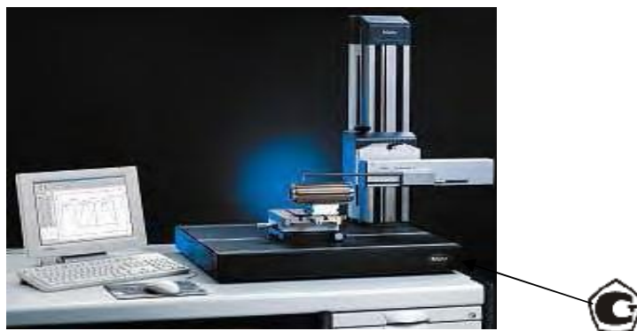
Рисунок 1 –Общий вид приборов для измерений параметров контура поверхности MarSurf XC 20
