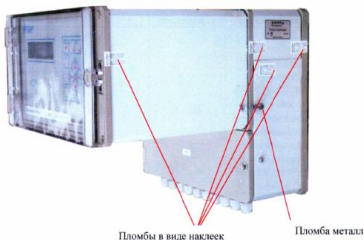
Рисунок 1 – Схема пломбирования УСПД RTU-325
