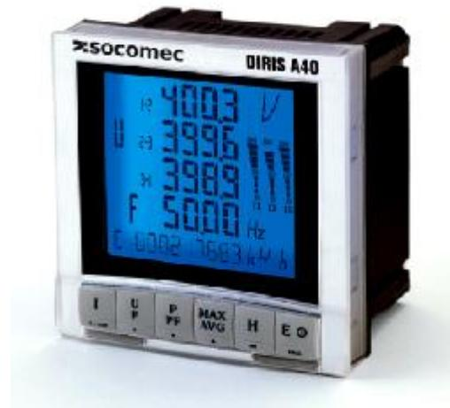
Измеренные и обработанные значения отображаются на жидкокристаллическом графическом дисплее, а впоследствии могут быть выведены и сохранены на персональном компьютере (PC) или промышленном контроллере (PLC) через RS485 порт с применением JBUS/MODBUS протокола с целью построения графиков, таблиц или дальнейшего анализа. Для переноса данных на компьютер и расширения функциональных возможностей в мультиметрах предусмотрено подключение дополнительных модулей на задней стенке прибора.
