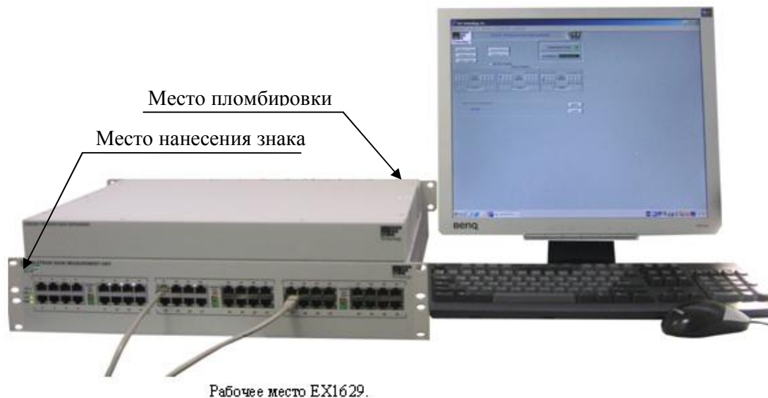
Рисунок 1 – Внешний вид тензостанции с указанием места нанесения знака утверждения типа и местом пломбировки
