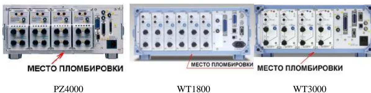
Рисунок 2 – Схема пломбировки от несанкционированного доступа.
