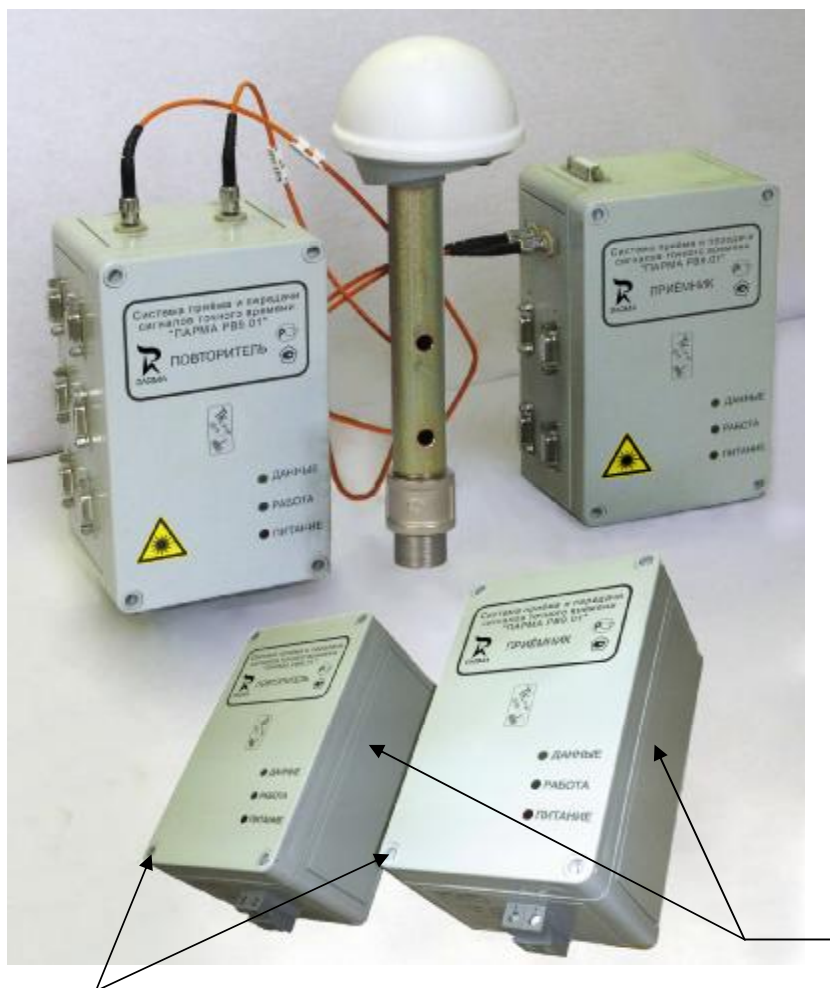
Рисунок 1- Внешний вид систем и мест для пломбирования, размещения наклеек (стикеров) с указанием зав. №, даты выпуска.
