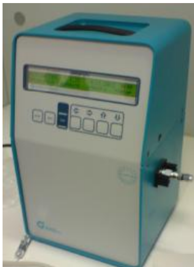
Рисунок 1 – Анализатор давления насыщенных паров MINIVAP LPG
