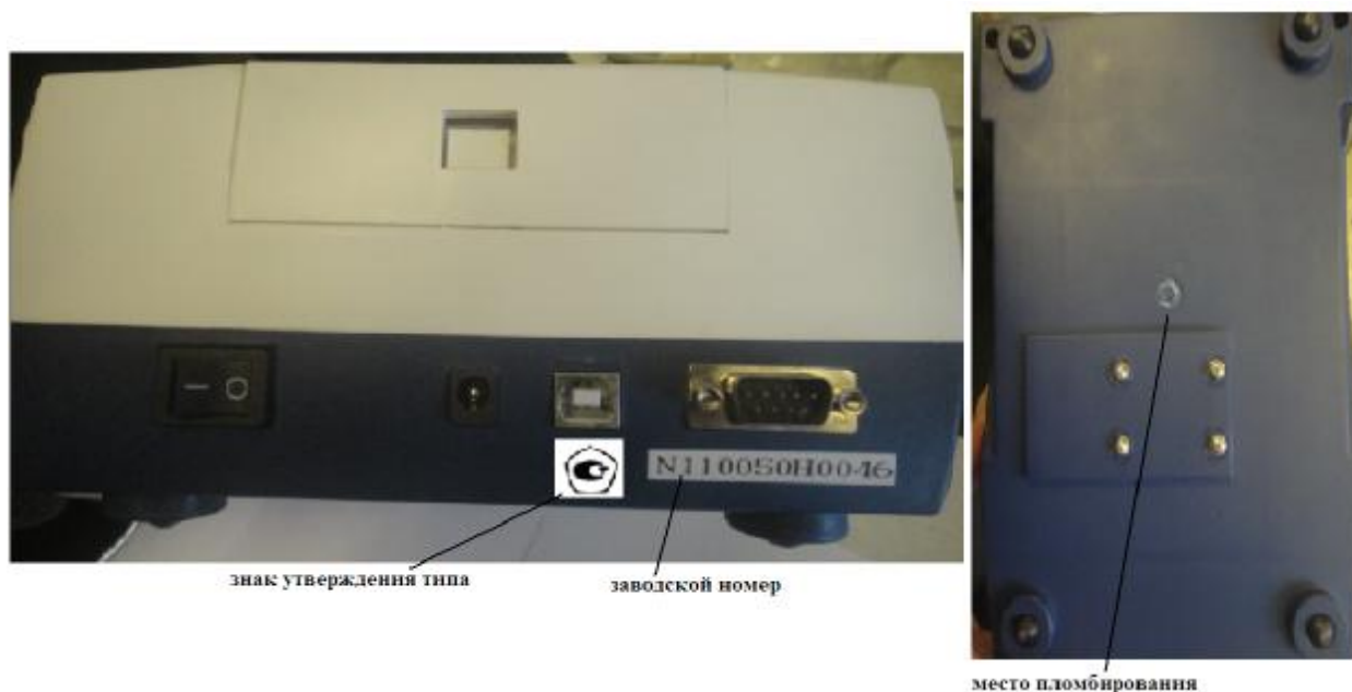
Рисунок 2 – Схема маркировки и пломбировки анализатора
