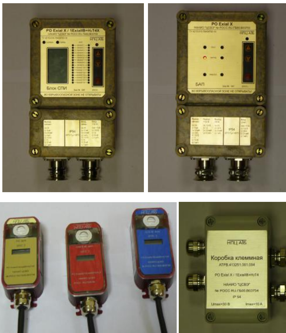
1 – блок СПИ; 2 - датчики ИТС2; 3 –БАП; 4 – КК.
