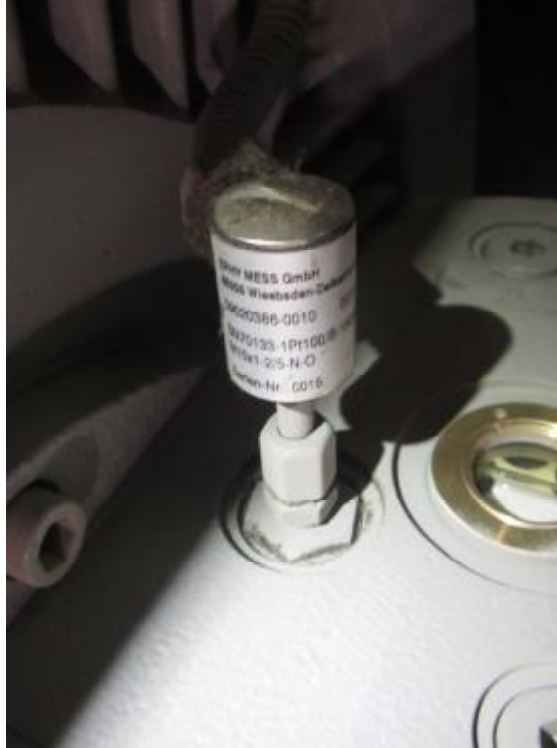
Рис. 1. Термопреобразователь сопротивления платиновый SN70133-1PT100/B-150x6S-M10x1-2/5-N-O.
