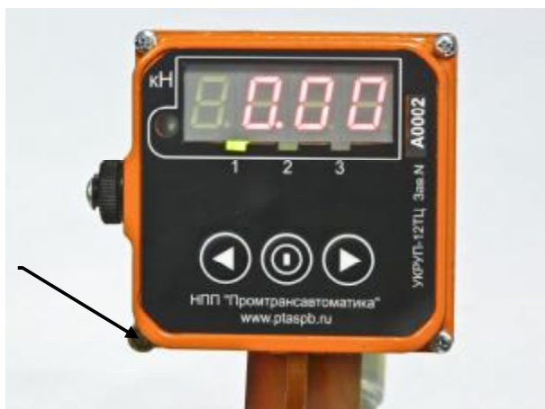
Рисунок 2 – Схема пломбировки от несанкционированного доступа
