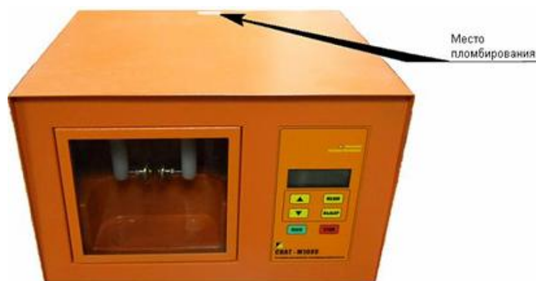
Общий вид аппаратов высоковольтных испытательных СКАТ-М100В
