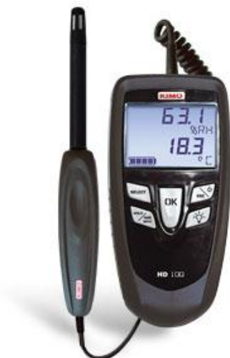
Рис.1. Термогигрометр модели HD 100
