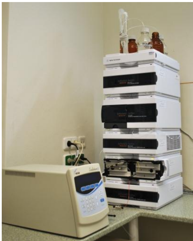
Рис. 1. Фотография внешнего вида хроматографа жидкостного Agilent модель 1260 Infinity LC с электрохимическим детектором Coulochem® III Electrochemical detector.
