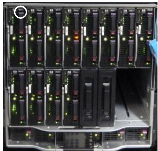
Рисунок 2 Место блокировки кассетного модуля (выделено)
