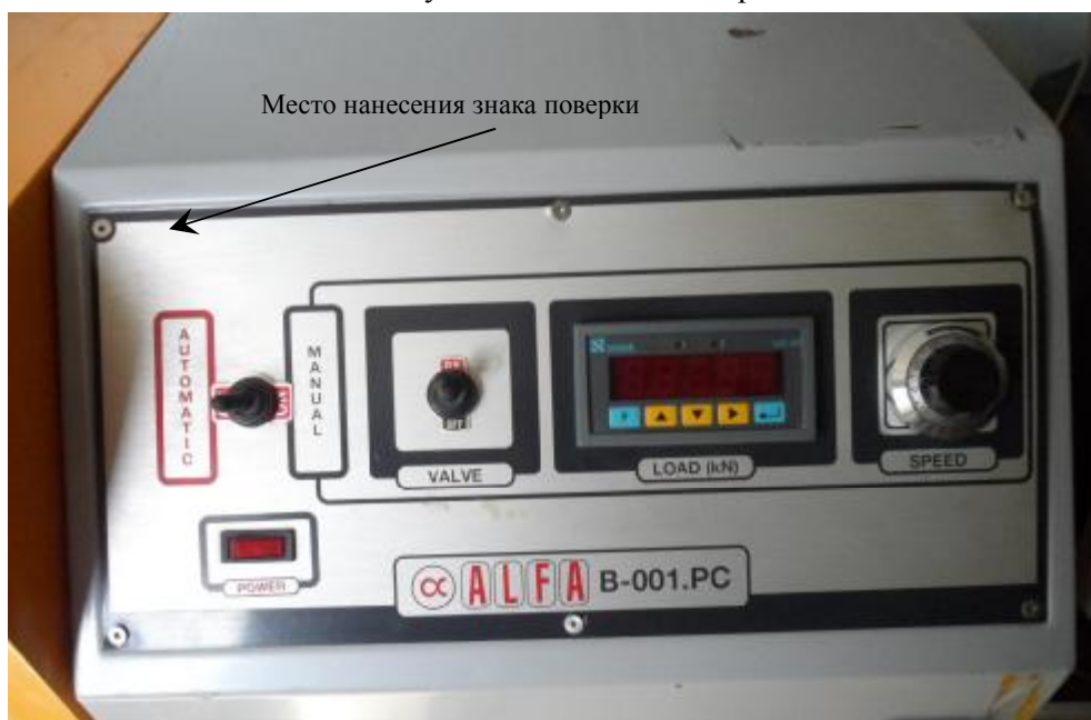
Рисунок 2 – Схема пломбировки пресса
