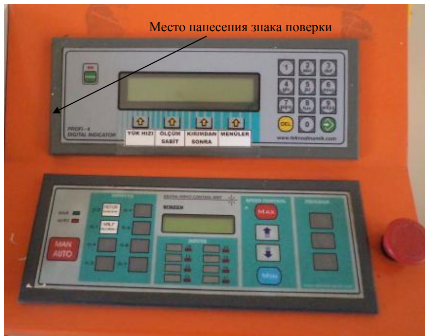
Рисунок 2 – Схема пломбировки прессы от несанкционированного доступа
