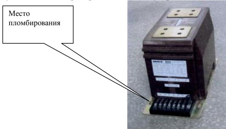
Первичные и вторичные обмотки залиты компаундом, который обеспечивает основную изоляцию и формирует корпус трансформатора. Выводы первичной обмотки выведены на верхнюю часть литого корпуса в виде контактных площадок с отверстиями для болтов М12. Вторичные обмотки выведены в литую коробку для зажимов, закрытую пластмассовой крышкой и расположенную у основания трансформатора на узкой боковой стенке. Крышка, закрывающая зажимы, пломбируется для исключения несанкционированного доступа.
