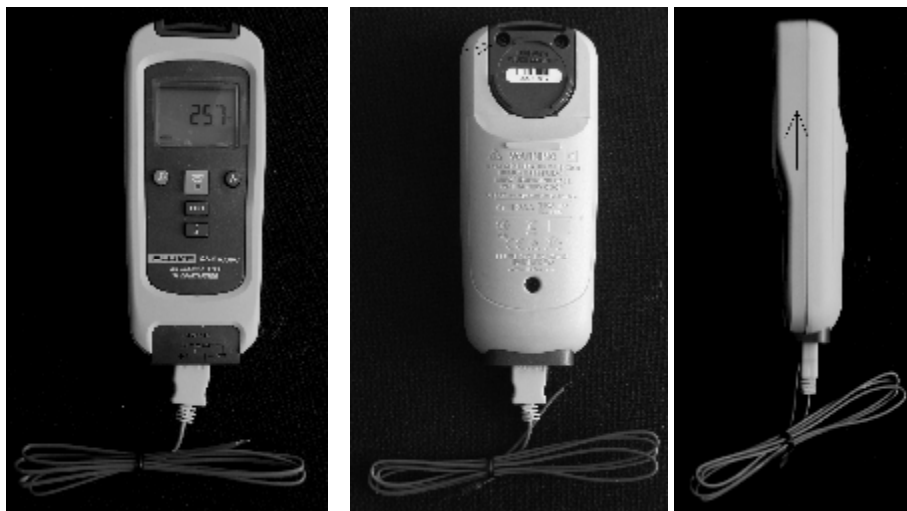
Рисунок 1 - Внешний вид измерителя температуры с функцией дистанционной передачи данных Fluke CNX t3000.
