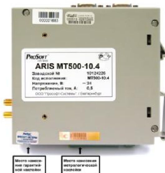
Рисунок 1 - Общий вид и места пломбирования контроллера ARIS MT500
