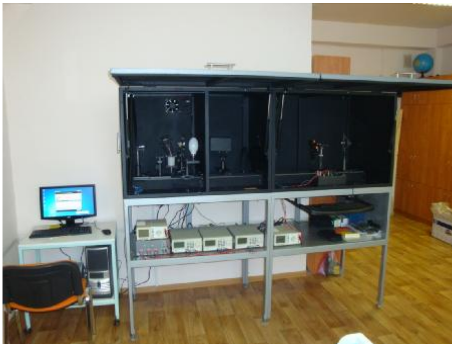
Рисунок 1 - Общий вид установки для поверки и калибровки люксметров, яркометров и пульсметров «СТИЛЬБ-7».
